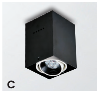
C 光源 :CREE-XP-E2 17W 色溫 :3000K,4200K 光學角度 :25° 40° 60° 材質 : 鋁材鐵框
