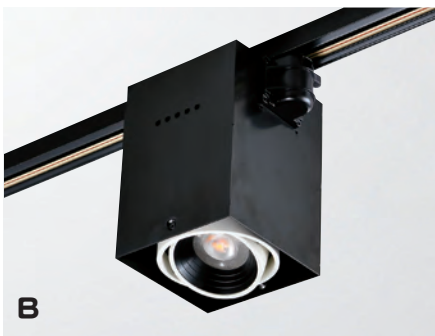
B 光源 :CREE-COB 20W 色溫 :3000K 光學角度 :40° 60° 材質 : 鋁製品
