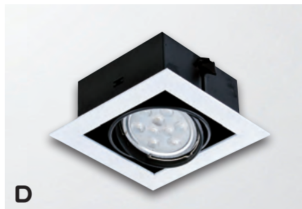
D 光源 :LED-AR111 12W 色溫 :3000K,5500K 光學角度 :25° 40° 60° 材質 : 鋁框鐵材
