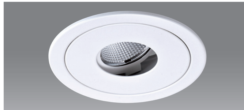
CT-91284 嵌入孔 90 mm 光源 MR16 LED A~F 材質 鐵製品 配件 防眩罩 顏色 □White 功能 可調角度 / 前維修 尺寸 Ø108mm H35mm
