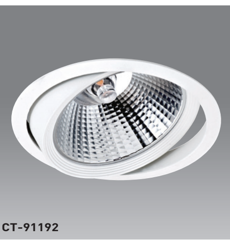
嵌入孔 130mm 光源 AR111 LED A~N 材質 鋁製品 顏色 □White ■Black 功能 可調角度 尺寸 Ø145mm H60mm
