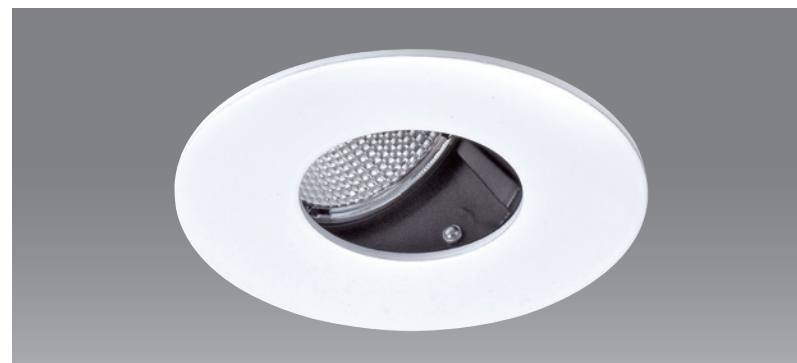
CT-91286 嵌入孔 78 mm 光源 MR16 LED A~F 材質 鋁製品 顏色 □White 功能 可調角度 尺寸 Ø87mm H50mm
