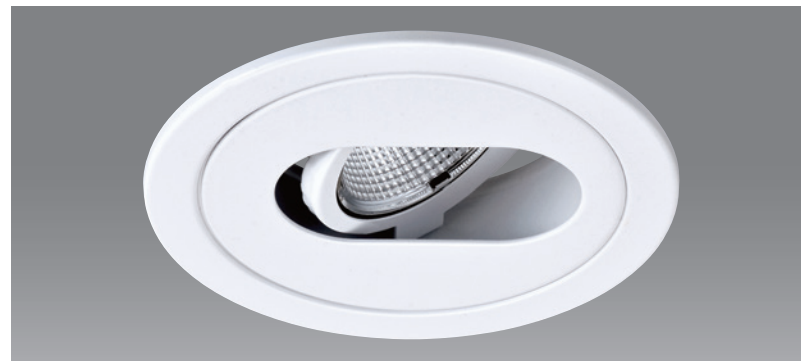
CT-91283 嵌入孔 90 mm 光源 MR16 LED A~F 材質 鐵製品 配件 防眩罩 顏色 □White 功能 可調角度 / 前維修 尺寸 Ø108mm H35mm
