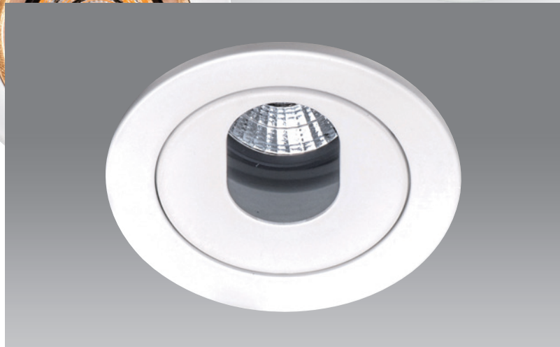
CT-91202 光源 CREE COB 8W 材質 鋁製品 CRI 90 色溫 3000K (4000K 5000K訂製品) 顏色 □ White 尺寸 Ø69mm H75mm
